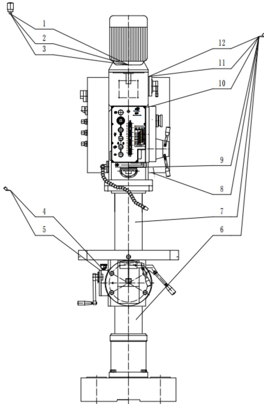
Рис. (6) Схема смазки
